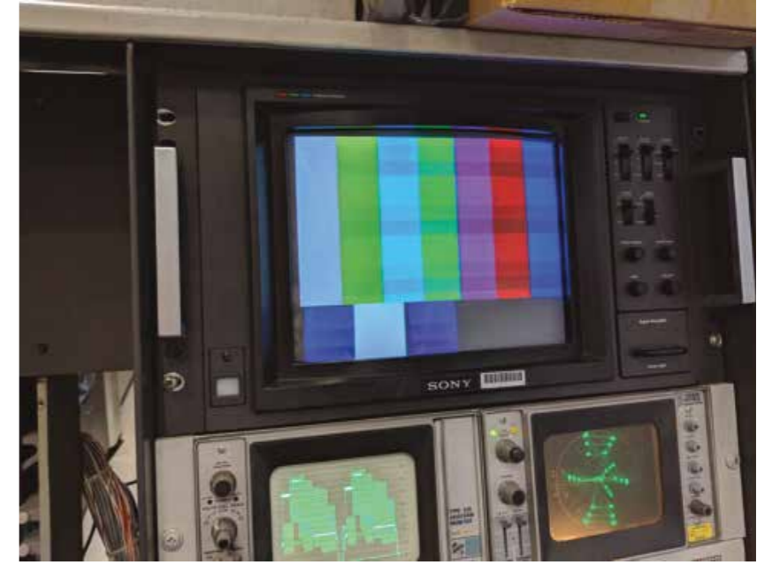
الشكل 12. شاشة عرض فيديو تظهر الخطوط اللونية الناتجة عن سوء المحاذاة بين الرؤوس.
