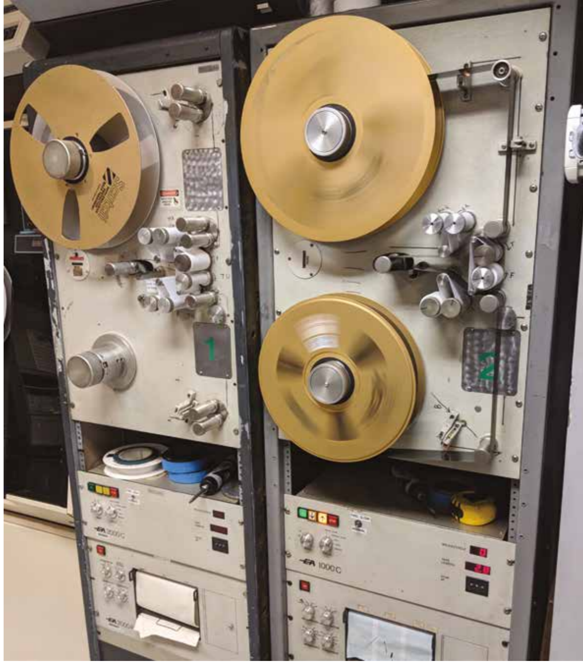
الشكل 6. أجهزة تنظيف الأشرطة للشريط المغناطيسي مقاس 2 بوصة. في الرف الذي يقع أسفل الجزء التشغيلي من جهاز التنظيف تجد أدوات التقييم التي تعد التقارير الخاصة بعملية التنظيف وتطبعها وتقدم تقييماً لحالة الشريط.
