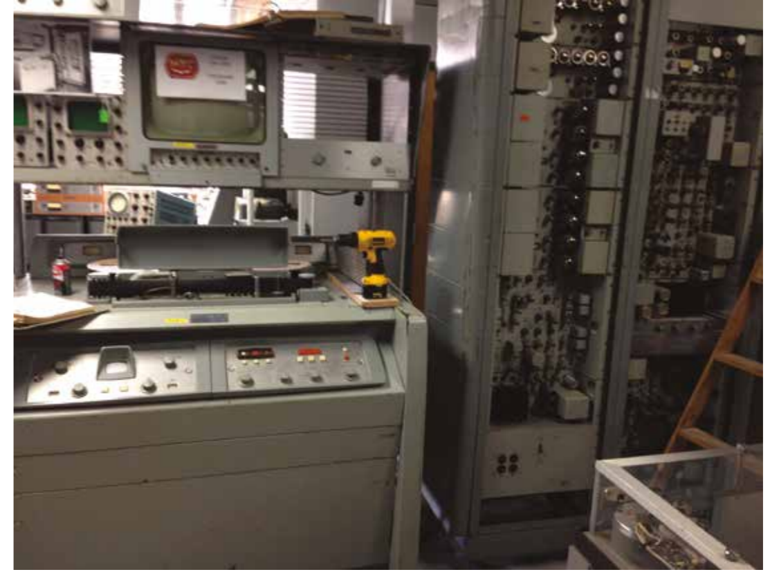
الشكل 1. جهاز VR-1000 من أمبيكس في متحف تكنولوجيا البث في مدينة وونساكيت بولاية رود آيلاند.
