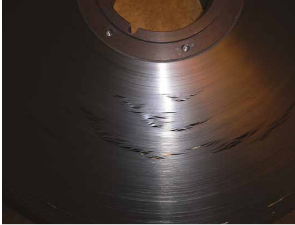
الشكل 5. أمثلة على سوء لف الشريط وتأثيراته على الشريط. تبين الصورة الأولى مثال على تجعد شريط مغطى بالأكسيد الأحمر وبالإضافة إلى التجعد فقد خرج الأكسيد من مكانه عند الحافة السفلية للشريط.
