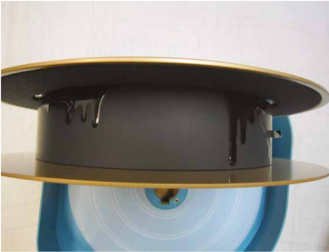
الشكل 4. حالة شديدة من حالات انفصال المادة اللاصقة عن الفلانشة المزودة بالفوم
