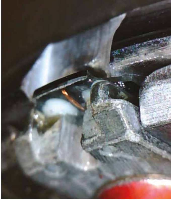
الشكل 10. أحد الرؤوس الأربعة في عجلة الرؤوس.
