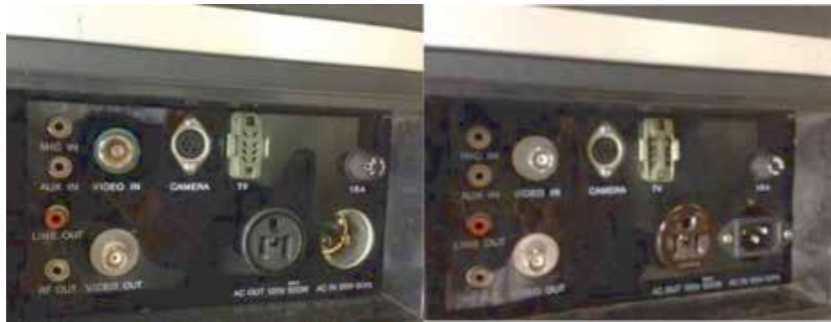
ج-3 الشكل 7. لوحة التوصيل الخلفي بجهاز Sony AV 3/8650 قبل وبعد تحديث الوصلات.
