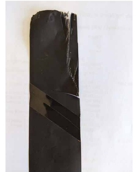
الشكل 15. شريط رباعي مقطوع بسبب الرؤوس بعد لحامه بشكل غير صحيح.
