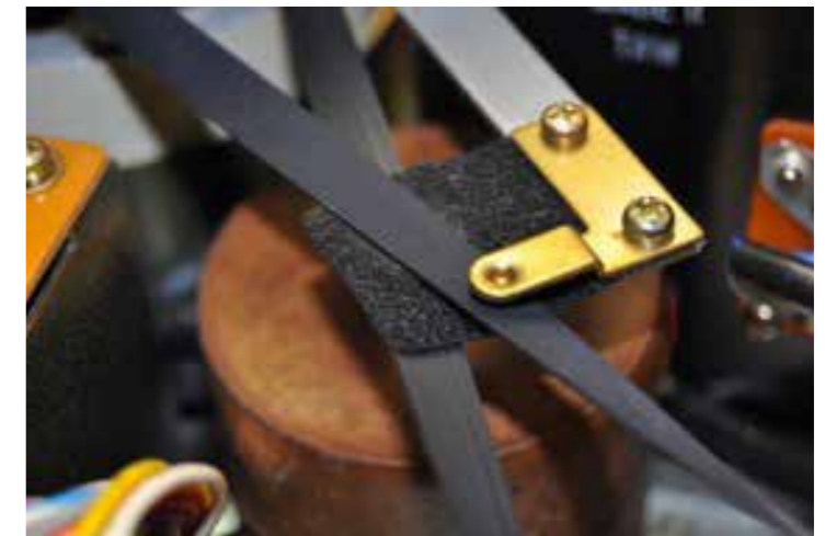
ج-3 الشكل 6. سيور يعبر فوق نفسه ووسادة منع الكهراء الاستاتيكية داخل مسجل أشرطة فيديو مفتوح البكرة مقاس نصف بوصة.
